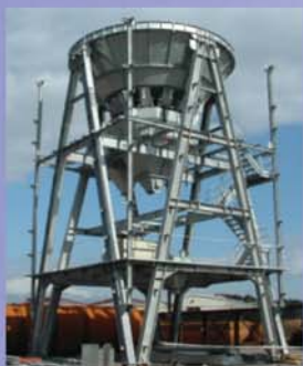
Struttura, scomparti e tramoggia inerti, bocchette, passerelle, scale, ecc.. ZINCATI A CALDO
