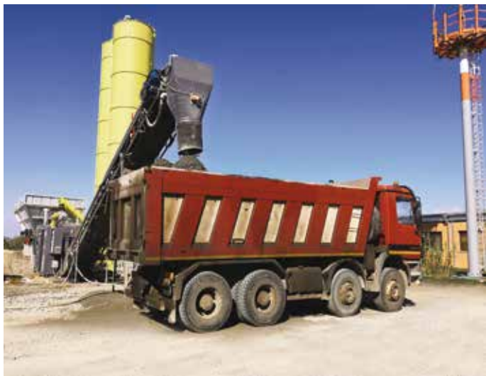
4. Il convogliatore di carico idoneo ad alimentare sia camion che autobetoniere
