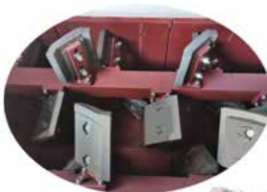
6. Il mescolatore MEC150 è dotato di rivestimenti in Hardox®
