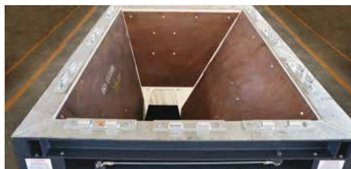
10. Le tramogge pesatrici possono essere rivestite in Hardox® 10. The weighing hoppers can be coated with Hardox®
