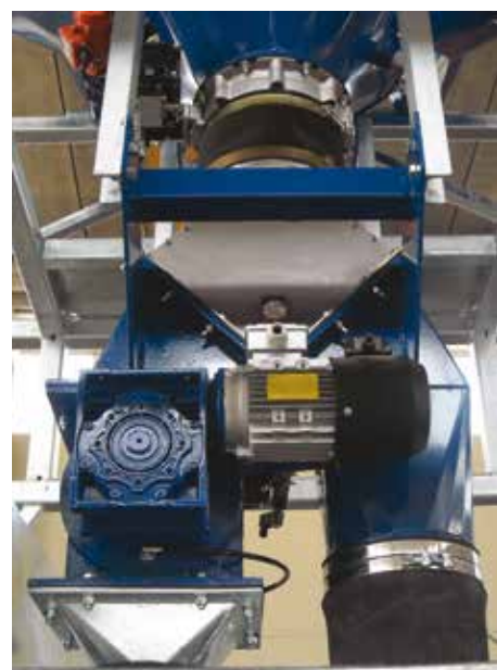
4. Il bypass per il dosaggio del cemento in modalità batch o continuo
