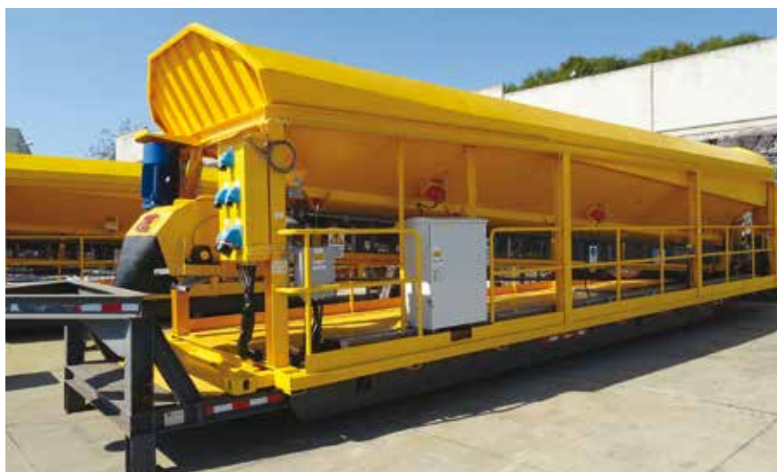
5. Il carro inerti ha una struttura modulare che consente di ampliare lo stoccaggio fino ad un massimo di quattro carrozze. È disponibile anche un'evoluzione che consente la gestione multiprodotto con pese integrate sul singolo vagone
