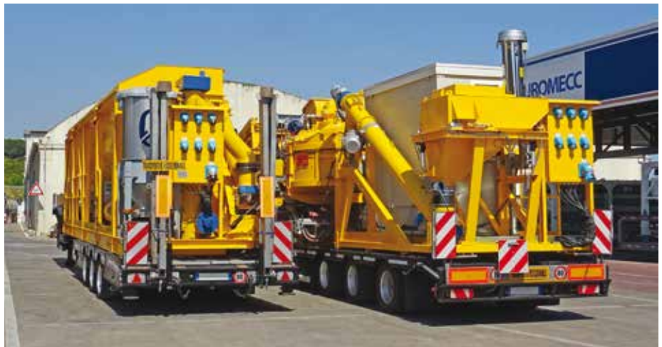
2. Ogni carro è completamente precablato e preassemblato in Euromecc, pur rimanendo idoneo al trasporto in sagoma stradale
