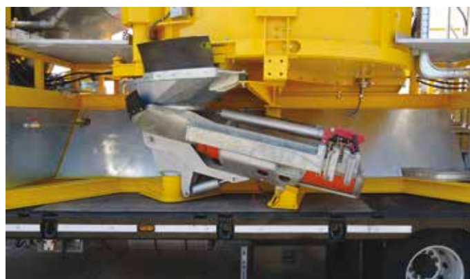
6. Le due canale di scarico mixer sono vincolate mediante perni e finecorsa nelle fasi di trasporto. Durante il getto vengono ruotate manualmente e successivamente mediante azionamento idraulico si estendono ed inclinano fino alla posizione richiesta
