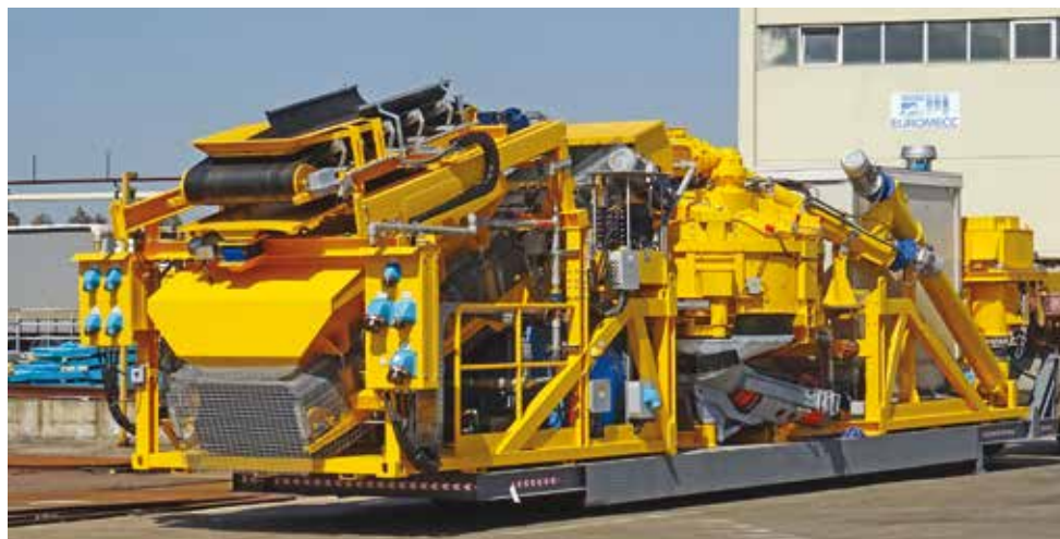
7. Per passare dalla configurazione di trasporto a quella di esercizio sono presenti dei manovellismi meccanici e idraulici che consentono il rapido collegamento degli organi di trasporto inerti e polveri
