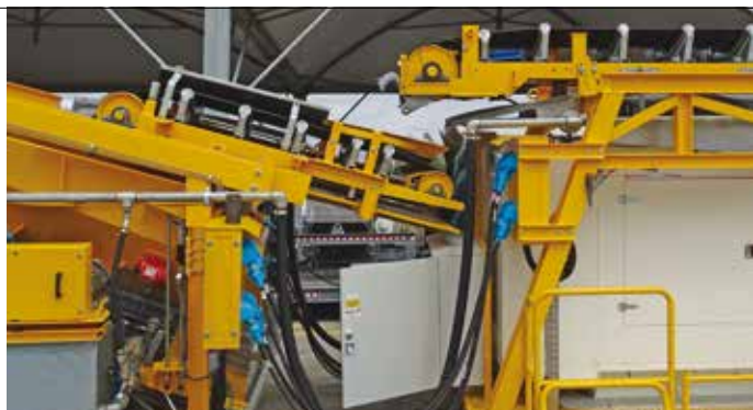
3. Il sistema di prese-spine industriali e sezionabili a pieno carico garantisce un elevato standard di sicurezza e viene utilizzato sia per il trasferimento dei segnali che per quello dell'alimentazione
