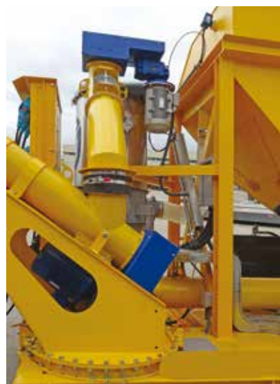
8. Per garantire la sicurezza durante le fasi di movimentazione, ogni elemento di connessione è equipaggiato con diversi perni di fissaggio collegati ad appositi fincorsa pronti a segnalare eventuali anomalie agli operatori
