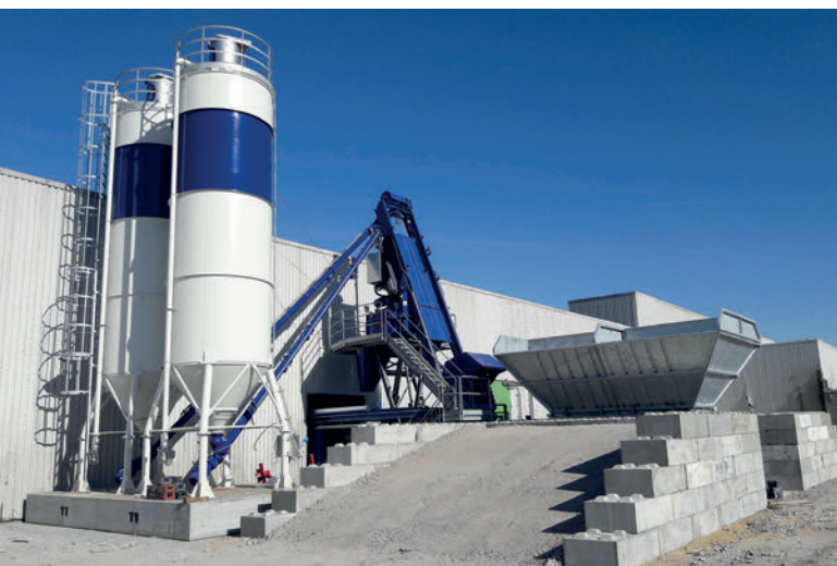
Centrale semi mobile avec un malaxeur planétaire de 1 m 3
