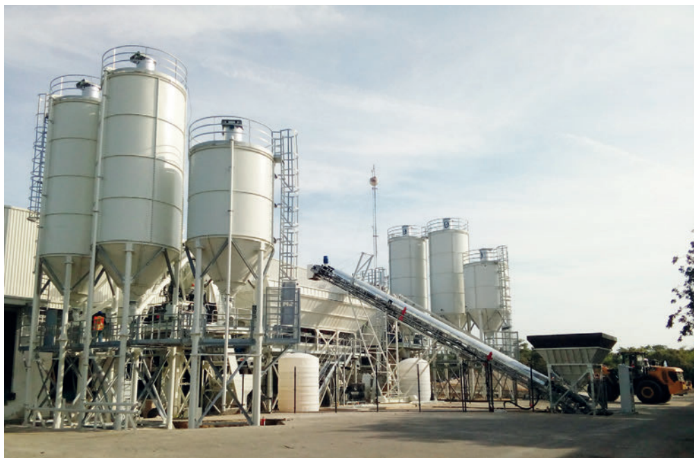
Centrale à béton fixe avec deux malaxeurs planétaires
