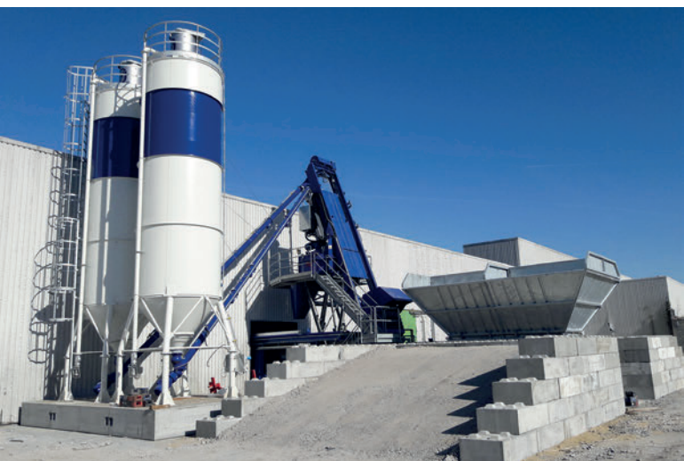
Centrale di betonaggio semi-mobile con miscelatore planetario da 1 m 3
