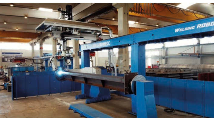
Dettaglio del posizionatore orbitale POR da 3.000 kg con contropunta
