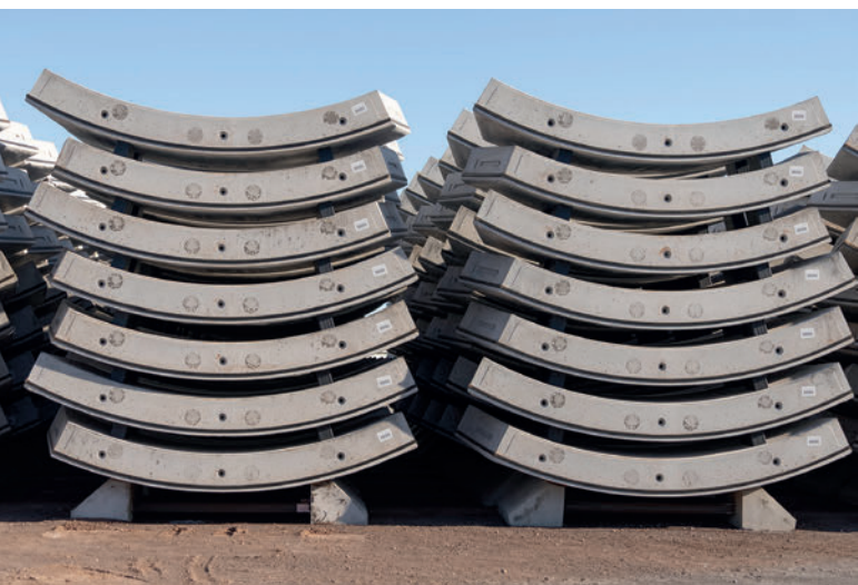
Vue des segments fabriqués
